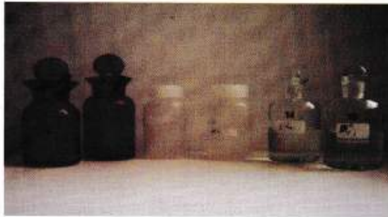
Gambar 9. Jenis-jenis wadah sampel air untuk analisa logam berat
