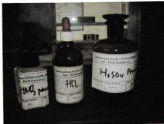
Gambar 7. Bahan kimia pengawet sampel air untuk analisa logam berat
